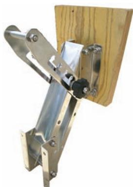
Транец выносной подъемный. Предназначен для крепления вспомогательного подвесного лодочного мотора. Имеет возвратную пружину, компенсирующую вес установленного двигателя и четыре фиксированных рабочих положения. Транцевая доска деревянная или пластмассовая, а остальные детали конструкции – из нержавеющей стали. Выбор выносного транца осуществляется в зависимости от мощности или веса подвесного мотора. Производитель SUMAR (Китай).
