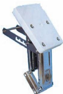
Транец выносной подъемный. Предназначен для крепления вспомогательного подвесного лодочного мотора. Имеет возвратную пружину, компенсирующую вес установленного двигателя и четыре фиксированных рабочих положения. Транцевая доска изготовлена из пластмассовая, а остальные детали конструкции – из нержавеющей стали. Выбор выносного транца осуществляется в зависимости от мощности подвесного мотора. Производитель Mancini&Mavimare (Италия).
